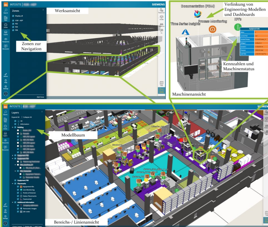
Bild 73: Entwickeltes Lösungskonzept sowie graphische Illustration der Umsetzungsergebnisse [P6]
